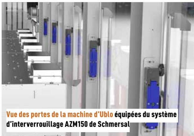
Vue des portes de la machine d'Ublo équipées du système d'interverrouillage AZM150 de Schmersal
