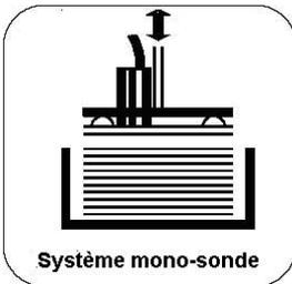
**Système mono-capteur de contrôle de double tôle universel**
